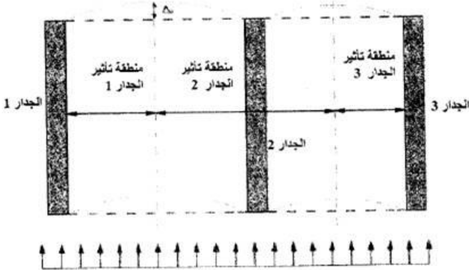
الشكل 19. أرضية تقليدية مرنة : منطقة التأثير للجدران. مكونات الزلزال في اتجاه الجدران 1-2 و 3.
